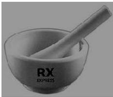
Mortar dan penumbuk (paste) digunakan untuk menumbuk atau menghancurkan materi cuplikan, misal : daging, roti atau tanah sebelum diproses lebih lanjut.
