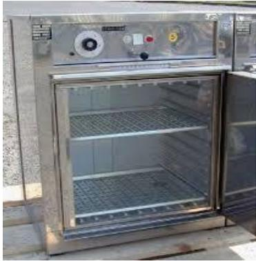
Oven adalah alat untuk mensterilkan alat-alat dari kaca yang digunakan dalam mikrobiologi, menggunakan udara kering. Suhu 170-180°C dan lama sterilisasi yang dilakukan biasanya 1,5-2 jam.
