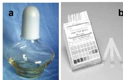
Salah satu alat yang berfungsi untuk menciptakan kondisi yang steril adalah pembakar Bunsen (**a**). Api yang menyala dapat membuat aliran udara karena oksigen dikonsumsi dari bawah dan diharapkan kontaminan ikut terbakar dalam pola aliran udara tersebut. Untuk
